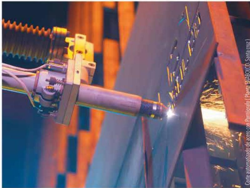
Corte automatizado de acero con Ramtoprofil (Planta ENABOLCO, Santa Cruz)
